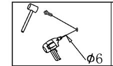
Bohren Sie mit einem 6mm Bohrer das angezeichnete Loch an und drücken den Dübel in das Loch.
