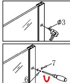
Nachdem Sie das Glaselement nochmals ausgerichtet haben, bohren Sie wie abgebildet ein Loch mit einem 3mm Bohrer in die Profilschiene bis zur ersten Luftkammer.
