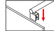
Setzen Sie den Stabilisator auf das Glas und schieben diesen ca. 5 bis 10cm von der Glasvorderkante ein. Schraube bitte nicht fest drehen.
