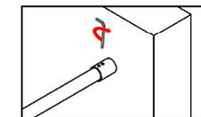
Schieben Sie den Stabilisator in die Hülse und setzen an-schließend die Halterung in das Glas. Ziehen Sie nun die Imbus-Schrauben an der Hülse fest.
