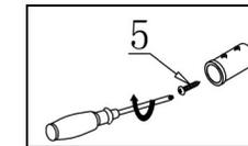
Richten Sie die Hülse nach dem Dübel aus und drehen Sie eine Schraube hinein.
