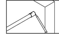
Richten Sie den Stabilisator horizontal mit einer Wasser-waage aus und setzen an der Außenkante eine Markierung.
