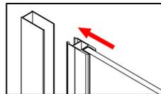
Schieben Sie das Glaselement in die Wandprofilschiene hinein und richten diese mit einer Wasserwaage aus.
