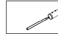
Richten Sie die Hülse des Stabilisators nach der Markierung aus und zeichnen innen das Bohrloch an.
