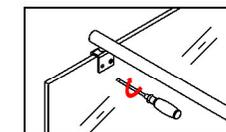
Richten Sie den Stabilisator am Glas nochmals aus und ziehen die Schraube so weit fest, bis Sie einen leichten Gegendruck spüren.
